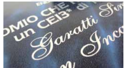
Particolare dell'incisione laser con scritte su sfondo colore a contrasto
