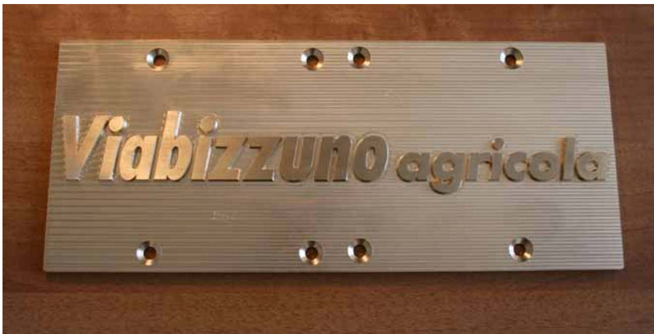
Targa in ottone ribassata a pantografo, con scritte a rilievo
